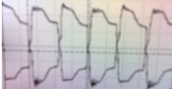
图 7 驱动电路耦合变压器的输出波形
